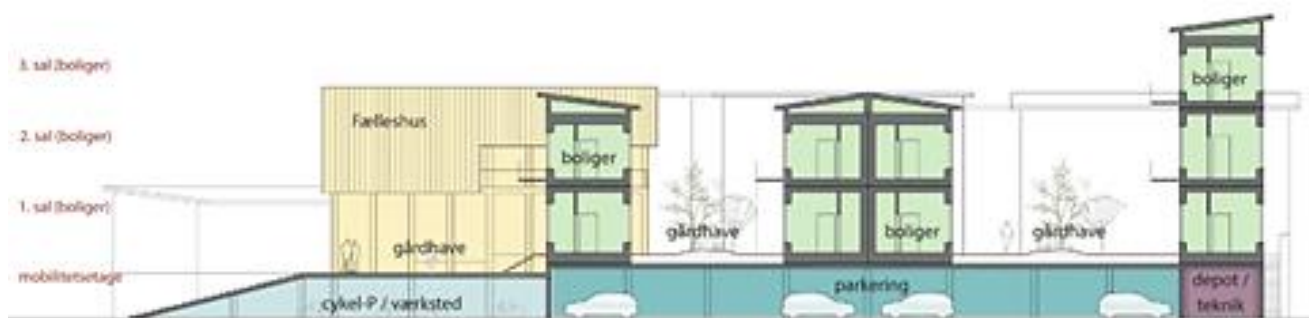
Figur 2.5: Principsnit for anvendelse af BF06. Snittet er vejledende og viser den principielle opdeling ml. mobilitetsetagen nederst og gårdhavedækket med boligerne ovenpå.
