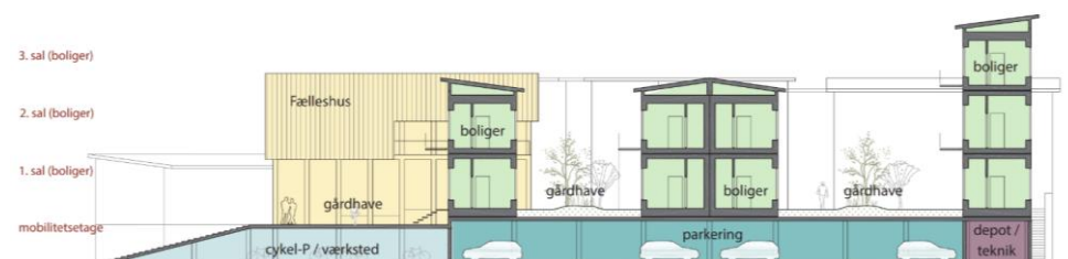
Figur 5: Principsnit for anvendelse af BF06. Snittet er vejledende og viser den principielle opdeling ml. mobilitetsetagen nederst og gårdhavedækket med boligerne ovenpå.
