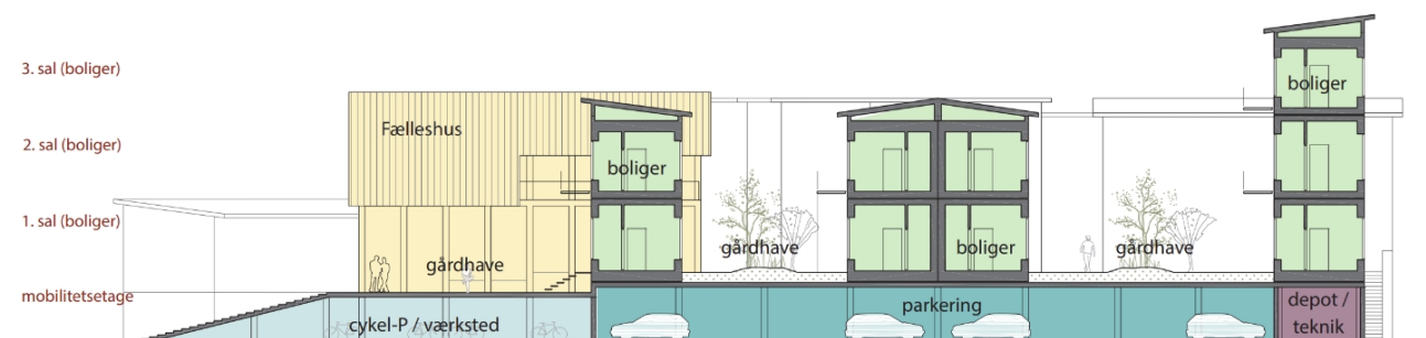
Figur 4 - Principsnit for anvendelse af BF06. Snittet er vejledende og viser den principielle opdeling mellem mobilitetsetagen nederst og gårdhavedækket med boligerne ovenpå.
